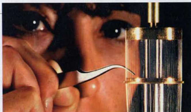
Configuration « Z-pinch ». Des fils d'acier dix fois plus fins qu'un cheveu sont disposés le long d'un cercle.
