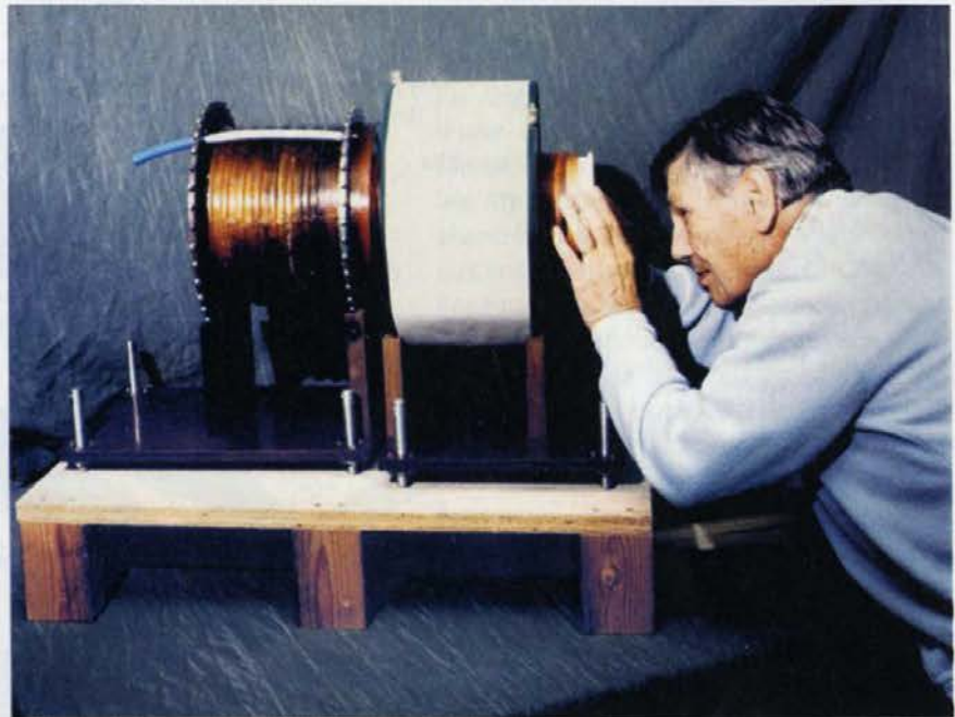
L'Américain Fowler, de Los Alamos, inspectant un générateur MK1 à Arzamas-16, Russie. En blanc: l'enveloppe explosive.
