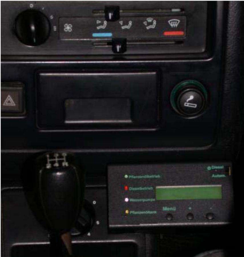
Das „Herzstück“ der Anlage, der Steuercomputer. Der Computer erfasst an mehreren Messpunkten die Temperaturen des Motors und Treibstoffsystems und mischt mit steigender Betriebstemperatur über ein 3-Wege-Ventil stufenlos immer mehr Pöl zum Diesel. Gestartet wird mit Diesel, bei warm gefahrenen Motor mit 100% Pflanzenöl. Vor Abstellen des Motors wird auf Diesel zurück geschaltet. Es ist aber auch ein Betrieb nur mit Diesel möglich, wenn zum Beispiel kein Pflanzenöl verfügbar ist.
