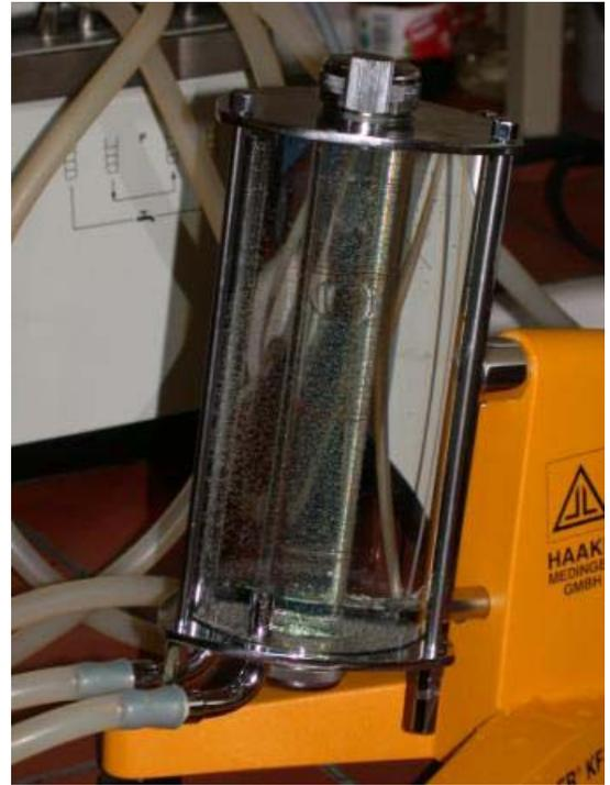
**Das eigentliche Kugelfallviskosimeter mit Wassermantel**
