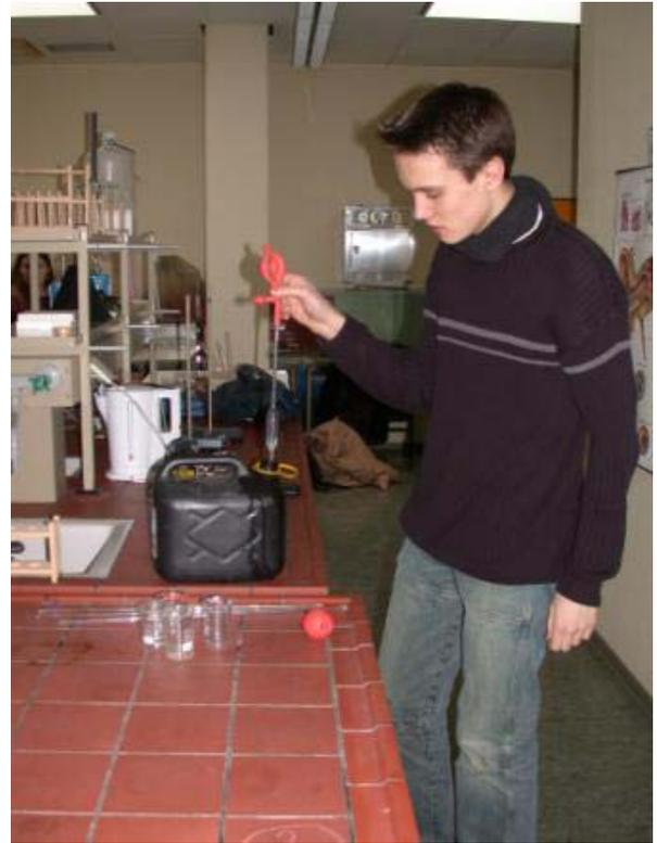
**Diesel wird für die Dichtemessung abpipettiert (Stefan)**
