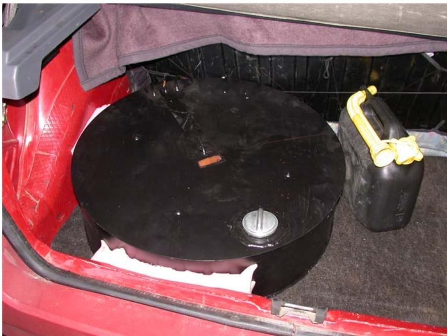
Im Kofferraum des Wagens befindet sich der 32-Liter-Pöl-Tank. Eigentlich für den Einbau in der Reserveradmulde vorgesehen, musste er hier im Kofferraum untergebracht werden, da dieser Wagentyp über keine Radmulde verfügt.
